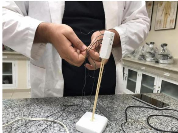
6) Conectar los leds con los alambres de cobre.
