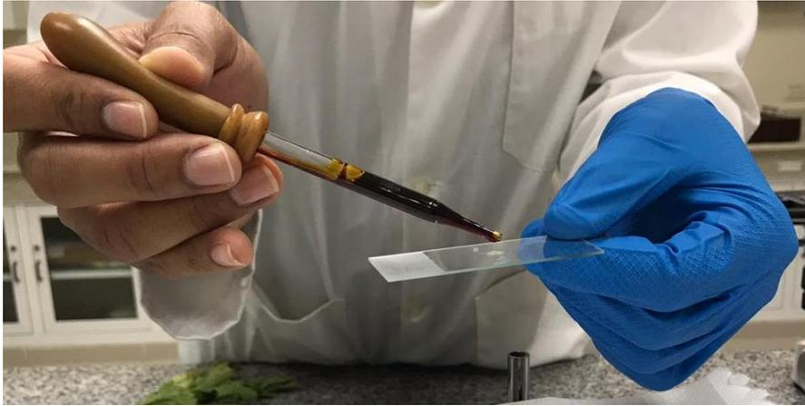
5) Colocar el cubre objetos y poner el portaobjetos en la platina; con los tornillos macrométrico y micrométrico se procede a enfocar la muestra
