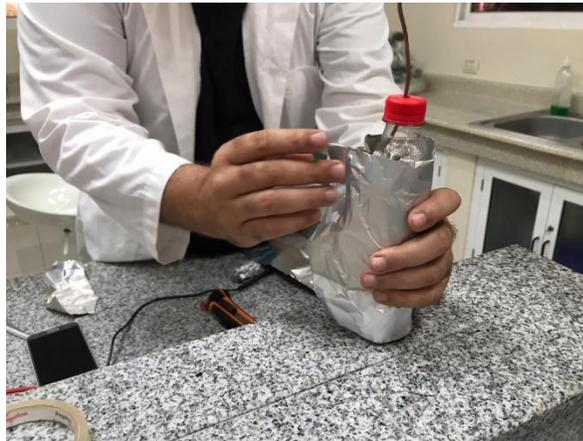
10) Uno de los extremos del alambre se coloca en el pote que haga contacto con el aluminio y aseguramos con cinta.
