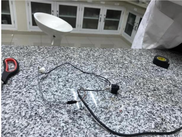
6) Se conecta la fuente y se observa como enciende el led al presionar el interruptor vemos como es interrumpido el circuito.
